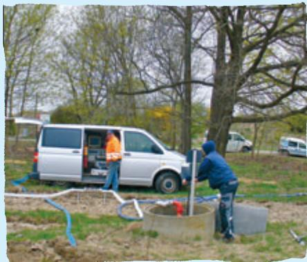
Zur Feststellung der Netzleistungsfähigkeit für das Gewerbegebiet Hühndorfer Höhe und das Bauvorhaben der Firma Eberspächer wurde eine Hydrantenabschlagsmessung durchgeführt.
