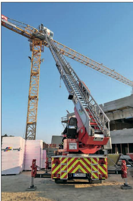
*Mittels Drehleiter kann die Rettungsplattform des Krans erreicht werden*
