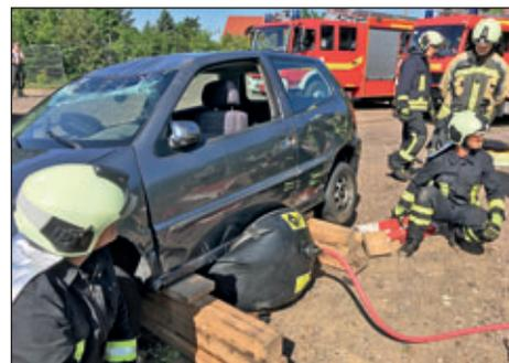
Anwendung eines Niederdruckhebekissens
