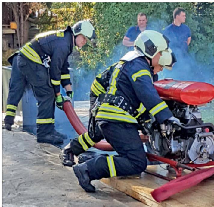
Wasserförderung mit der Tragkraftspritze
