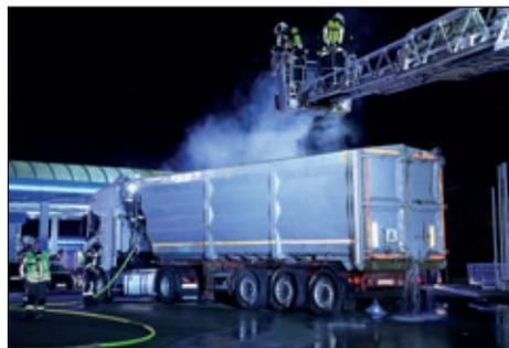
*Eine Ammoniakwolke wird über die Drehleiter mit feinem Sprühnebel niedergeschlagen.*
