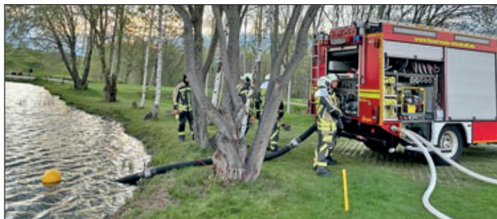
Maschinisten fördern Wasser aus einer Wasserentnahmestelle über die Fahrzeugpumpe zur Einsatzstelle.
