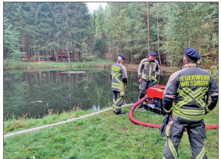
Löschwasserentnahme aus offenem Gewässer mit der Tragkraftspritze
