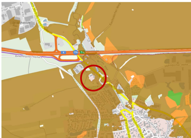
Abbildung 9: iDA - interdisziplinäre Daten und Auswertung (LfULG) braun: Lehm L orange: sandiger Lehm sL grün: stark lehmiger Sand SL
